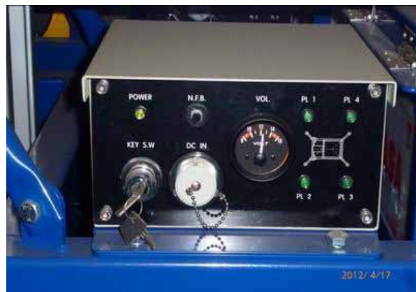
紅色(直流機種為綠色)指示燈亮表示送電，可 進行昇降操作作業
