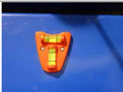
德國製造 T 型水平指示器 (調水平時氣泡大約在格子內即可)
