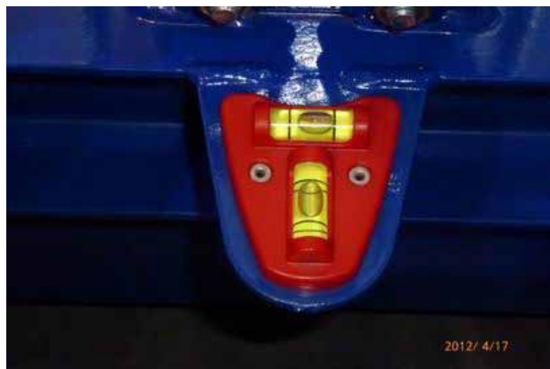
德國製造 T 型水平指示器 (調水平時氣泡大約在格子內即可)
